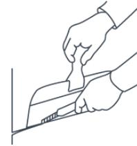
Verarbeitung an Außenkanten: Mit feinem Nassschleifpapier ( $\geq$  P 240) das Produkt an der Kante leicht anschleifen (nicht durchschleifen!), um die Außenkante legen und blasenfrei andrücken.
