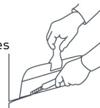
Angle sortant : Poncer légèrement les angles à l'aide d'une toile-émeri ( $\geq$  P 240), rabattre, éventuellement couper ou utiliser une baguette d'angle.
