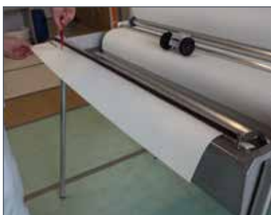
La coupe de la bande s'effectue au niveau du bord de coupe sur la partie avant du bac d'immersion. Sur la dernière bande seulement, coupez au niveau du bord de coupe juste devant le compteur.
