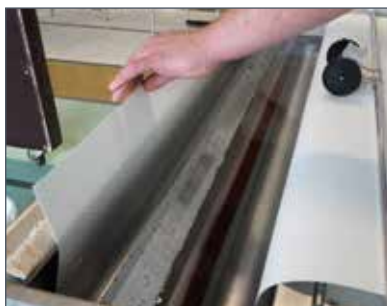
Une fois que la bande de tissu ou de non-tissé est enfilée, le clapet racleur d'eau est relevé.
