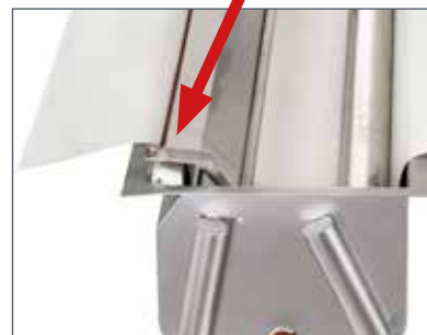
En position de fonctionnement, le clapet racleur d'eau repose sur la bande de tissu ou de non-tissé. Un réglage selon les besoins ne peut être réalisé qu'à l'aide de la vis de réglage. Cela est notamment utile en cas : - de températures extrêmes - d'exigences particulières (par ex. ouverture difficile)
